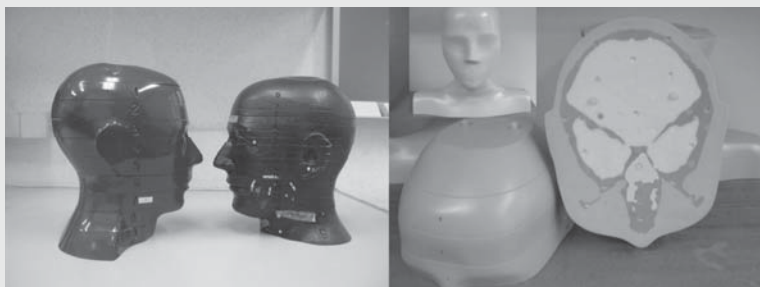
그림 1. 유효선량을 측정하기 위해 사용되는 인체 해부학적 구조와 장기를 모사한 RANDO® 팬텀
