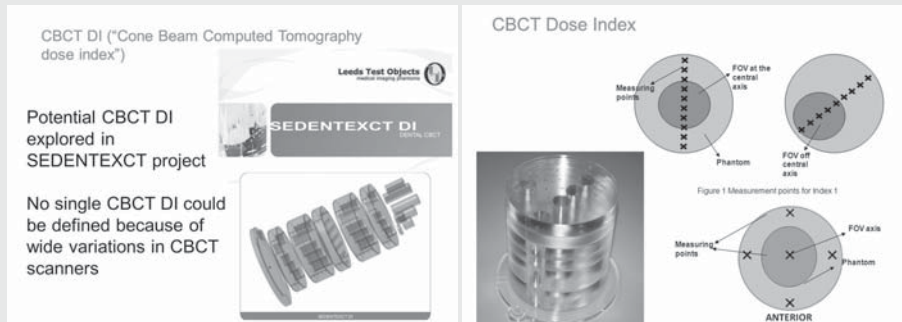
그림 5. 다양한 조건을 갖는 CBCT장치의 CTDI를 측정하기 위해 고안된 팬텀과 측정방법
