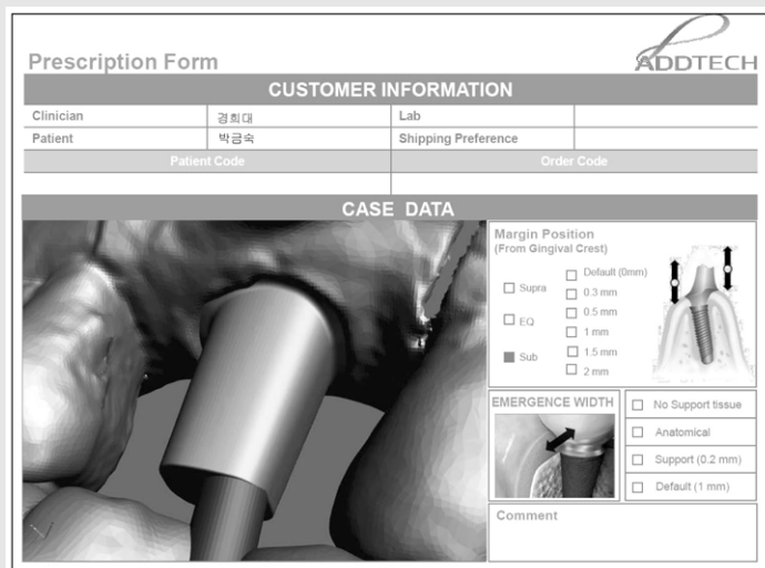
그림 10. CAD로 디자인된 형태를 술자가 직접 확인하고 수정할 수 있어야 한다. 제조회사에 따라서는 STL file을 PDF file에 embedding 시켜 술자가 디자인된 상태를 확인할 수 있다.
