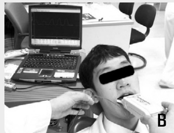
Fig. 6. 스트레인지티 교합력 측정 장비와 기존 레퍼런스 장비들과의 비교 실험. A: Prescale 시스템과의 비교 실험, B: T-scan III와의 비교 연구
